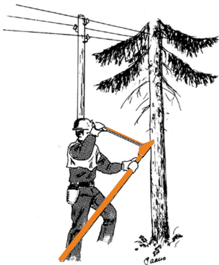
Bild 7. Fälldomkraften är ett av specialverktögen för fällningsarbete.
